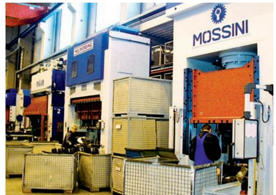
**Hydraulik- und Exzenter Einlegepressen**
