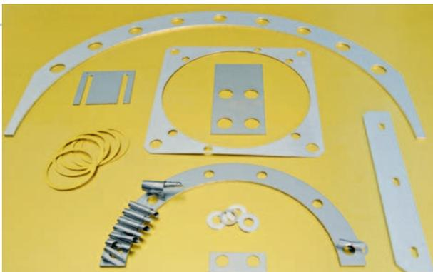
**Große Vielfalt:** Zwischenlagen, die aus 1200 mm x 600 mm großen Schichtblech-Standardtafeln mit 0,5 bis 3,2 mm Dicke gestanzt werden. Der Anwender schält die Schichten bis zur gewünschten Dicke selbst ab. Die Oberfläche ist rückstandsfrei
