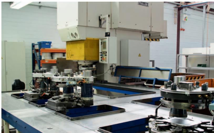
**Bewährt:** Ein Werkzeug-Verschiebesystem mit optischer Erkennung und Ausrichtung ermöglicht schnelle Rüstvorgänge
