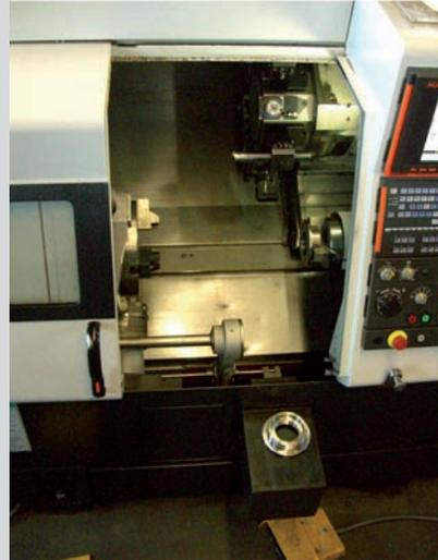
CNC- Drehmaschine, (Mazak QTN 200M)
