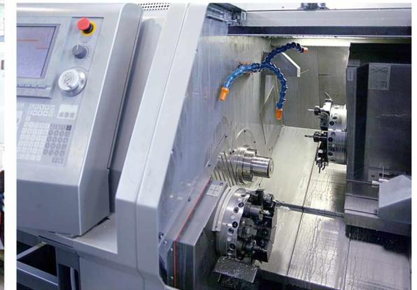
Abgestimmt auf Geometrie, Grösse und Stückzahlen der Drehteile sind CNC-Drehmaschinen, Bearbeitungszentren teil- und vollautomatisiert im Einsatz.
