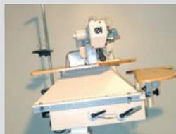
Tischplatte in Neigung von -10° bis + 10° stufenlos einstellbar
