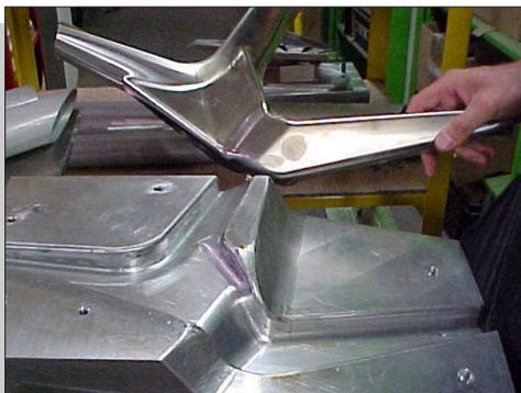
Abb. 8: Streetstepper, Blechboxunterrohr
