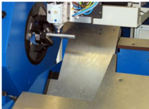
La TruLaser Tube 5000 permet d'usiner à la fois les tubes et profilés standards et les profilés plus spéciaux. Les champs d'application caractéristiques de la machine sont la fabrication de tuyauteries, de cadres, de supports et de charpentes porteuses.
