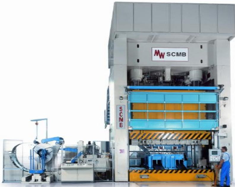
Tuschierpresse mit 4.000 kN und einer Tischfläche von 3.000 mm x 3.000 mm (Druckgusswerkzeuge)
