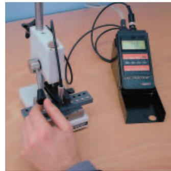
Zur Qualitätskontrolle gehören Schichtdickenmessungen und Korrosionsschutztests.
