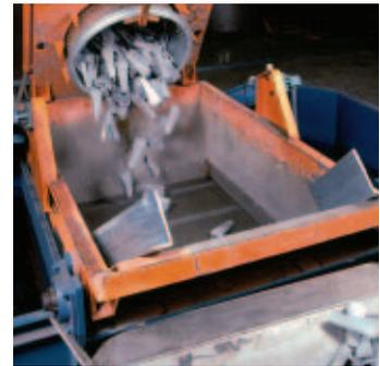
Von links oben: Computergesteuertes Befüllen der Körbe, Tauchbad, Zentrifugieren und Entleeren der fertigen Teile
