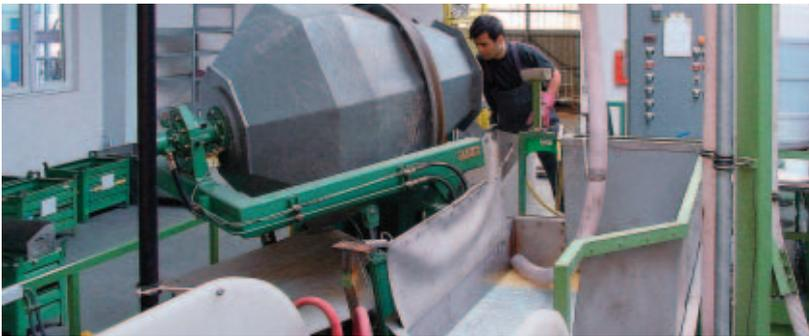
In den Beschichtungstrommeln wird ohne Wärmezufuhr das Metallpulver auf die zu bearbeitenden Teile aufgebracht.
