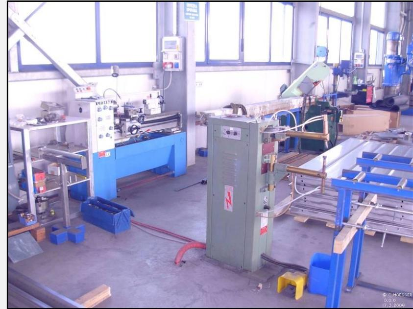
Kleine Drehbank und Widerstandspunktschwiessmaschine
