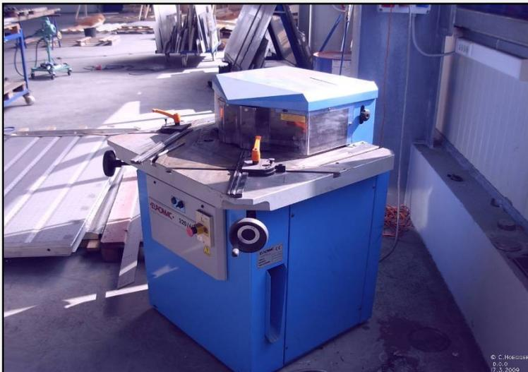
Auslinkmaschinen 30° bis 140°; bis 4 mm Edestahl 4301
