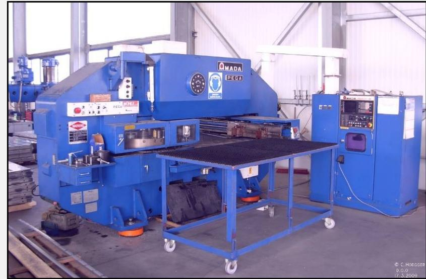
CNC Stanzmaschine: 30 t, Breite:1000 mm x 2000 mm
