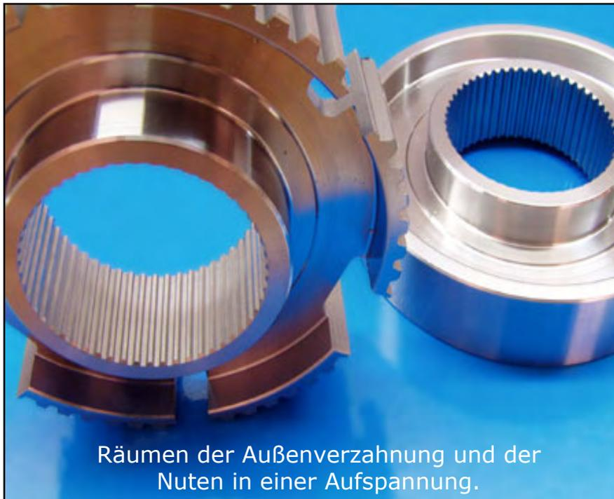
Räumen der Außenverzahnung und der Nuten in einer Aufspannung.
