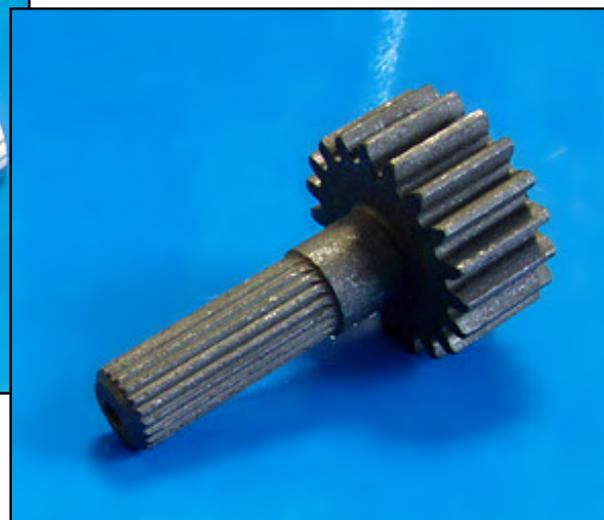
Auch die Rändelung kann im Zaronverfahren mit nur einer Spanstufe erfolgen. Die hier sichtbaren Späne werden durch einen Freistich am Rohling vermieden
