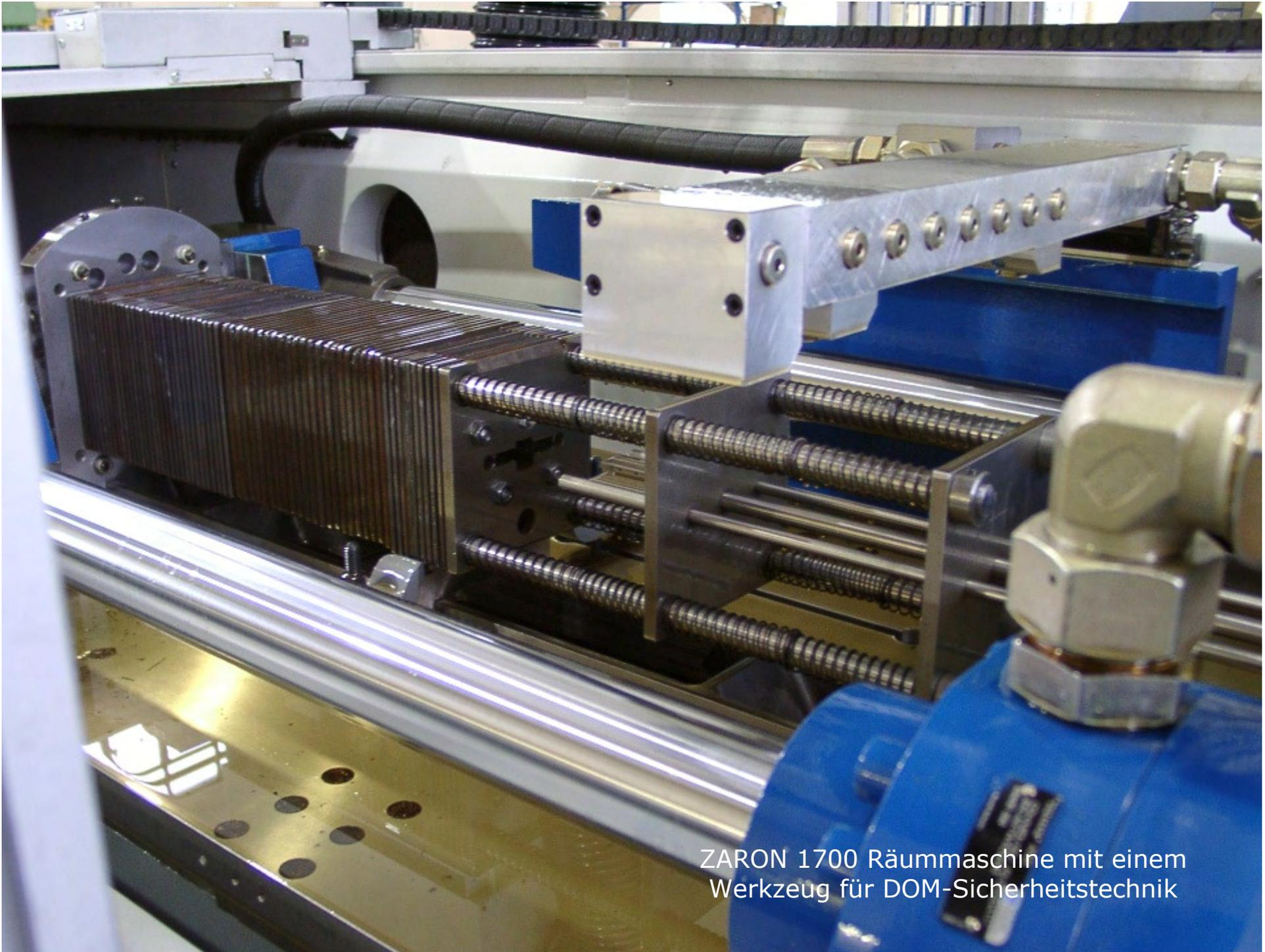
ZARON 1700 Räummaschine mit einem Werkzeug für DOM-Sicherheitstechnik
