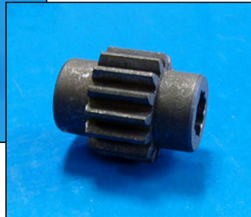
Antriebsritzel in verschiedenen Bearbeitungsstufen, innen- und außengeräumt - als Fertigteil gehärtet und antifricor-beschichtet
