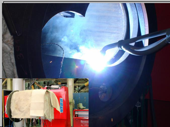
Das Stellit wird im Gehäuseinnenraum aufgeschweißt.
