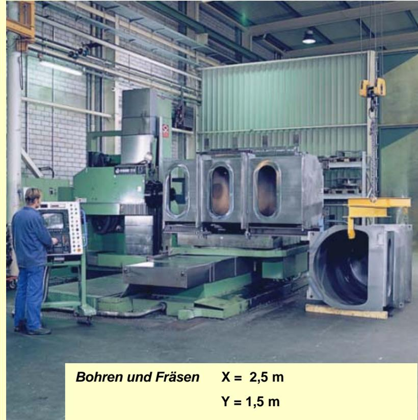
*Bohren und Fräsen* X = 2,5 m
