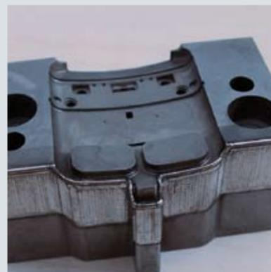
Reparatur eines Spritzgusswerkzeuges durch präzises Laserauf-tragschweißen
