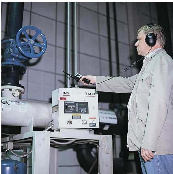
Mit **Ultraschalldetektoren** können Leckagen schnell und sicher erkannt werden, sogar aus mehreren Metern Entfernung. Ein integrierte Laser hilft bei der punktgenauen Ortung.
