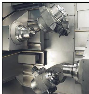
Arbeitsraum entnommen, und der Kurzklader, für Stangen bis  $\varnothing 65$  und einer Länge vom 1000mm, sorgt für Materialnachschub. Die Drehspindeln haben eine max. Drehzahl von 5000 U/min. und die Frässpindeln von 18.000 U/min.
