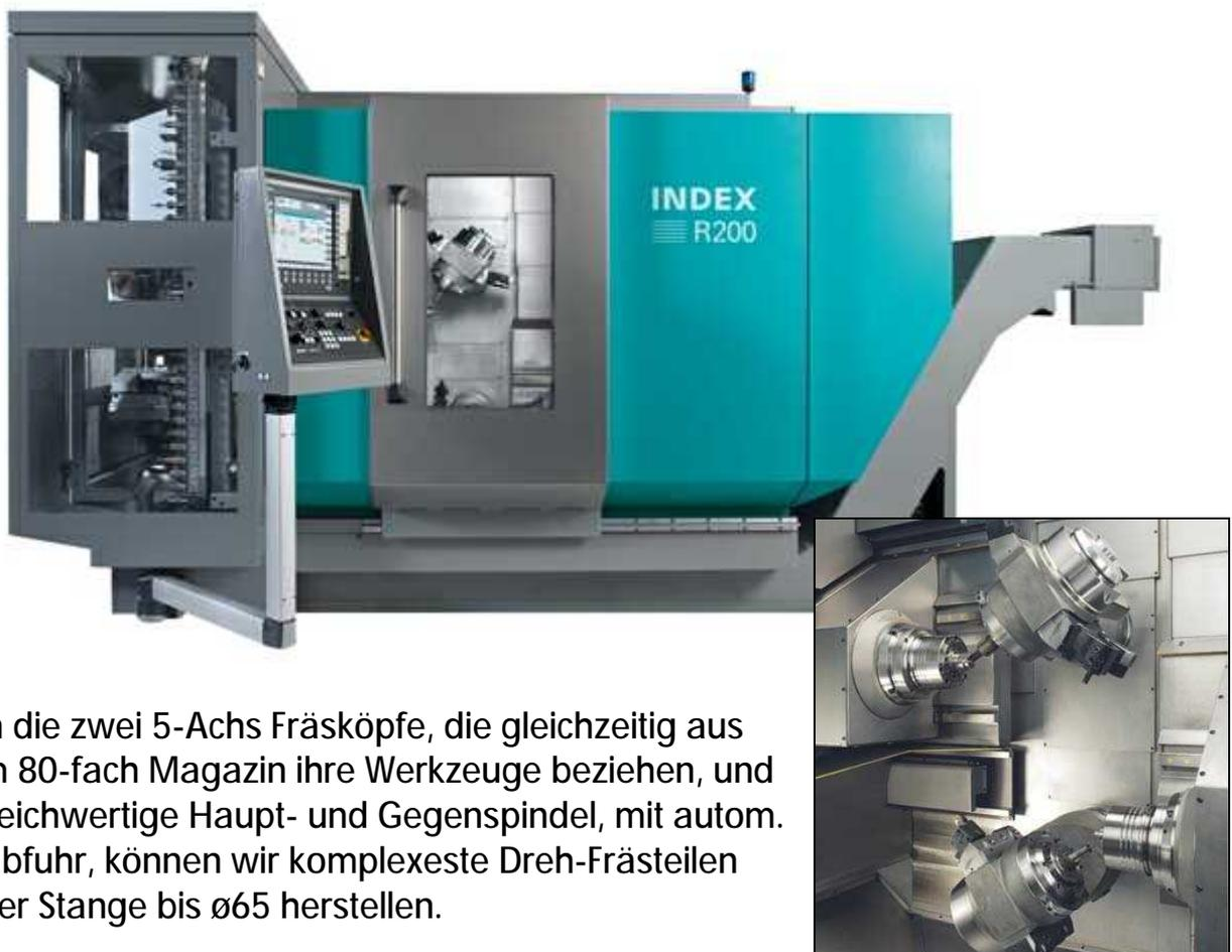
Durch die zwei 5-Achs Fräsköpfe, die gleichzeitig aus einem 80-fach Magazin ihre Werkzeuge beziehen, und die gleichwertige Haupt- und Gegenspindel, mit autom. Teileabfuhr, können wir komplexeste Dreh-Frästeilen von der Stange bis  $\varnothing 65$  herstellen.
