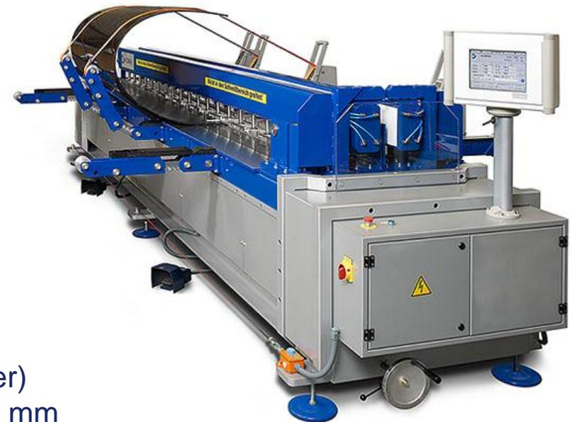
Stumpfschweißmaschinen für Kunststoffplatten
