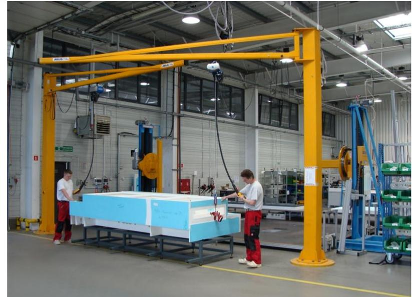
Dreh- und Hebevorrichtung für Behälter- und Beckenbau
