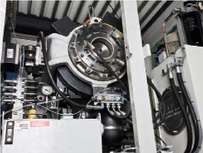
Herzstück des innovativen Antriebskonzepts ist ein einbaufertig ausgelieferter Komplett-Torquemotor 1FW3 von Siemens.
