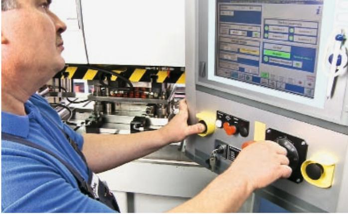
Nur Servopressen erlauben ein feinfühliges Verfahren des Stößels bei vollem Arbeitsvermögen mit dem elektronischen Handrad. So können Produktionspressen komfortabel eingerichtet und auch als Versuchspresse genutzt werden.
