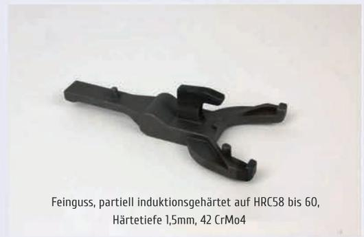
Feinguss, partiell induktionsgehärtet auf HRC58 bis 60, Härtetiefe 1,5mm, 42 CrMo4
