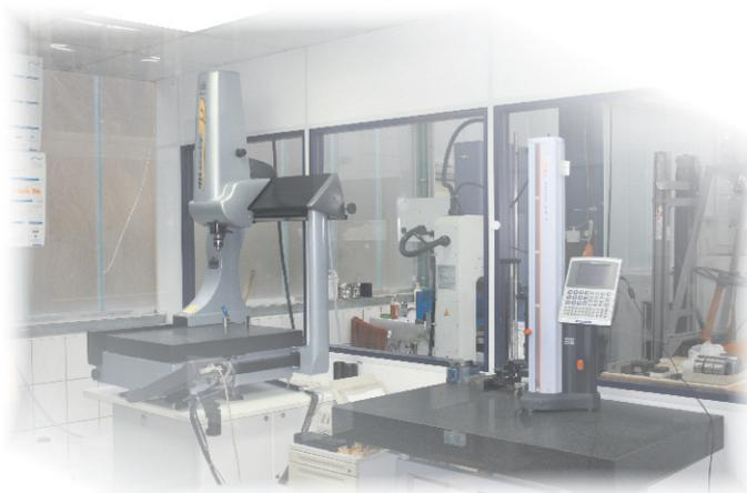
Unser klimatisierter Messraum mit 3D-Messmaschine, Hochgenauigkeitshöhenmessgerät, und Form- und Rundheitsprüfgerät von Hommel, geben uns Gewissheit über die gefertigten Maße, die wir selbstverständlich protokolliert den gefertigten Teilen mitliefern können.
