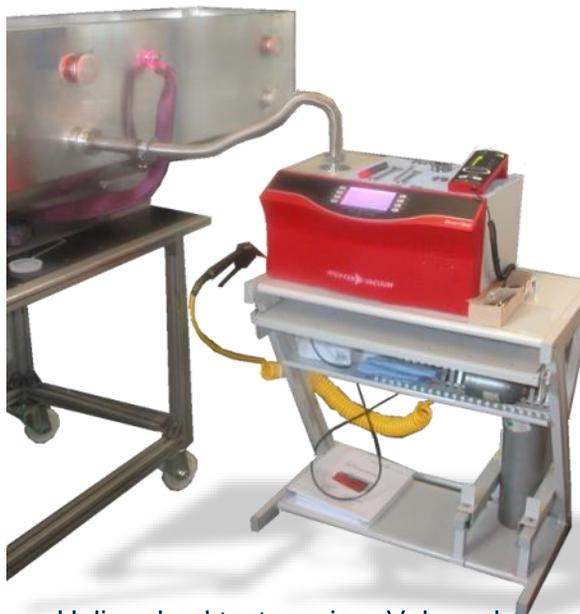
Helium-Lecktest an einer Vakuumkammer
