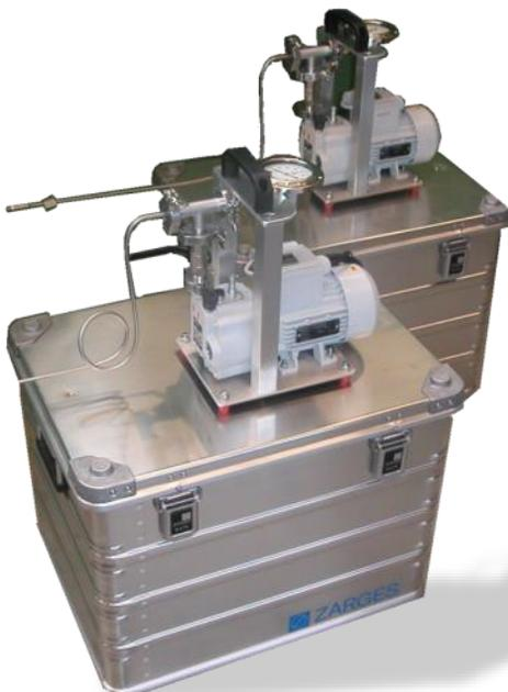
Spezielle Vakuumpumpstände für den Einsatz in der Kerntechnik mit Transportkiste
