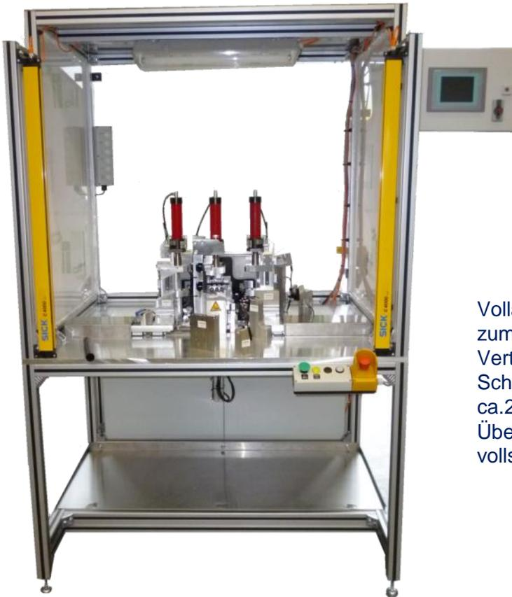
Vollautomatische Montagevorrichtung zum Aufschieben von Steckern, Verteilern und Steckergehäusen auf Schläuche bei einer Taktzeit von ca. 25 Sekunden von Teil zu Teil. Überwachung und Überprüfung der vollständigen Montage.
