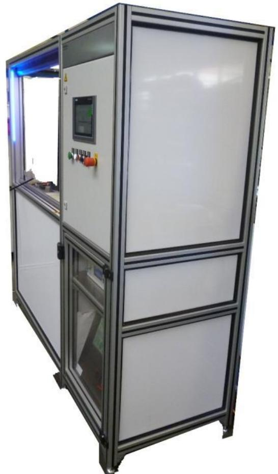
**Druckprüftisch mit Druckstation bis 40bar**
