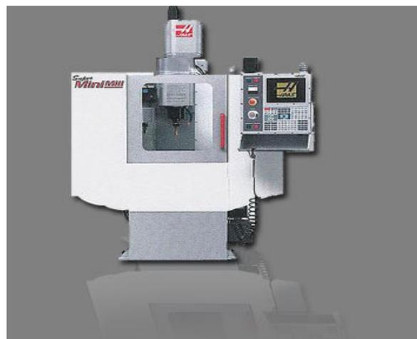
Super Mini Mill (Fräsmaschine)
