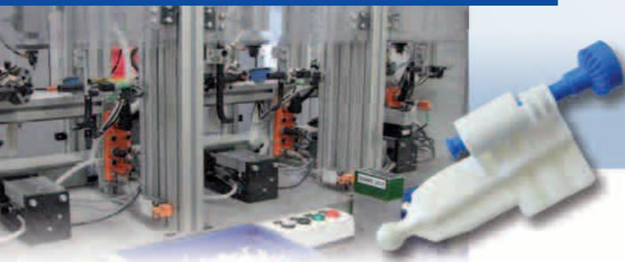
Montageautomat mit integrierter Prüfeinheit für mehrere Varianten.
