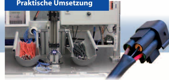
Kabelsteckvorrichtung mit Farb-, Verrast und Längenprüfung.
