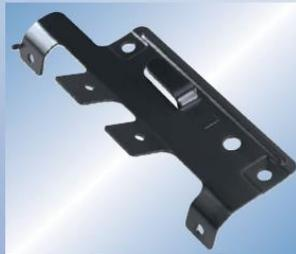
Befestigungswinkel - Material DC01 2mm - Stanz-/Biegeteil - pulverbeschichtet /KTL
