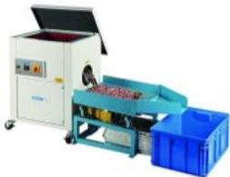
**1** **Entgratmaschine TROWI 95 mit Seperator**
