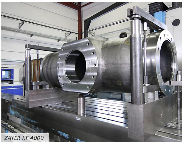
Mit unseren CNC-gesteuerten Fräsmaschinen/Bearbeitungszentren können wir Werkstücke bis zu einem maximalen Stückgewicht von 10 t und mit Abmessungen von 3.700 x 1.200 x 1.000 mm bearbeiten.
