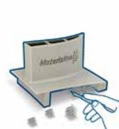
*Entfernung der Stützen und Endbearbeitung des Bauteils*
