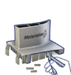
*Entfernung der Stützen und Endbearbeitung des Bauteils*
