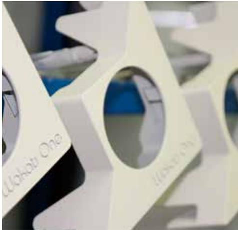
Produkte, die in Silikonformen hergestellt werden, sind qualitativ mit Spritzgussteilen vergleichbar, sodass sie besonders für Form- und Passprüfungen, zu Marketingzwecken oder für eine Endfertigungsreihe geeignet sind.
