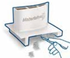
Entfernung der Stützen und Endbearbeitung des Bauteils
