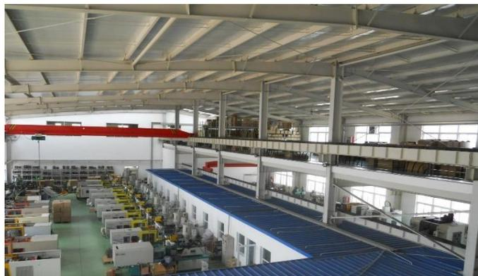
Produktionshalle, fertig gespritzte Teile werden über Förderbänder in die Nachbearbeitung (unter dem blauen Dach) geleitet
