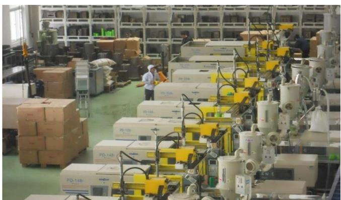
Alle Maschinen verfügen über Entnahmegereäte und werden über eine Zentrale Materialversorgung beschickt
