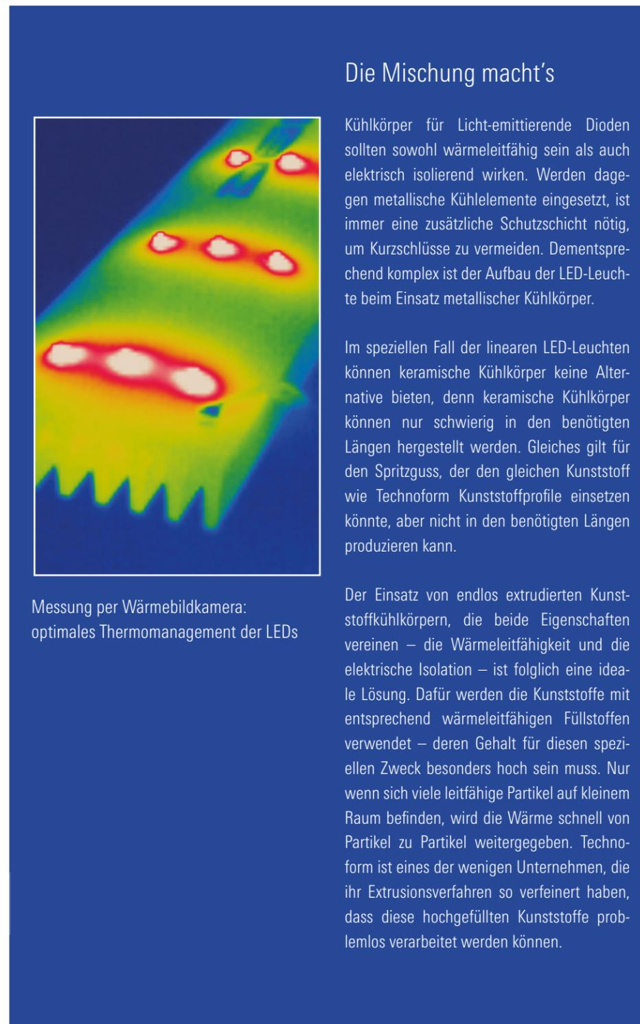
Messung per Wärmebildkamera: optimales Thermomanagement der LEDs
