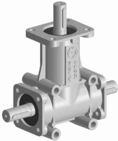
Unsere Kegelradgetriebe der Firma Poggi erlauben eine effiziente rechtwinklige Umlenkung des Antriebs. Hochwertige Komponenten wie GLEASON-spiralverzahnte Kegelräder und Kugellager namhafter Hersteller sorgen gemeinsam mit einer Lebensdauerschmierung für die hohe Effizienz und Laufruhe der Getriebe.
