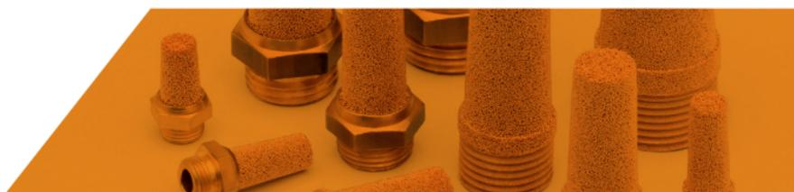
Die Schalldämpfer und Standardfilter der Reihe BRONFIL<sup>®</sup> sind gesinterte Bauteile mit erhöhter Porosität, die aus kugelförmigen Partikeln aus Bronze 89/11 gefertigt werden.
