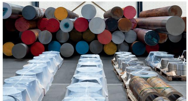
Auf mehr als 30 Horizontalbandsägen konfektionieren wir rechteckige und runde Stabstahlabschnitte bis zu 1.500 x 2.000 mm bzw. bis zu 1.500 mm Durchmesser.
