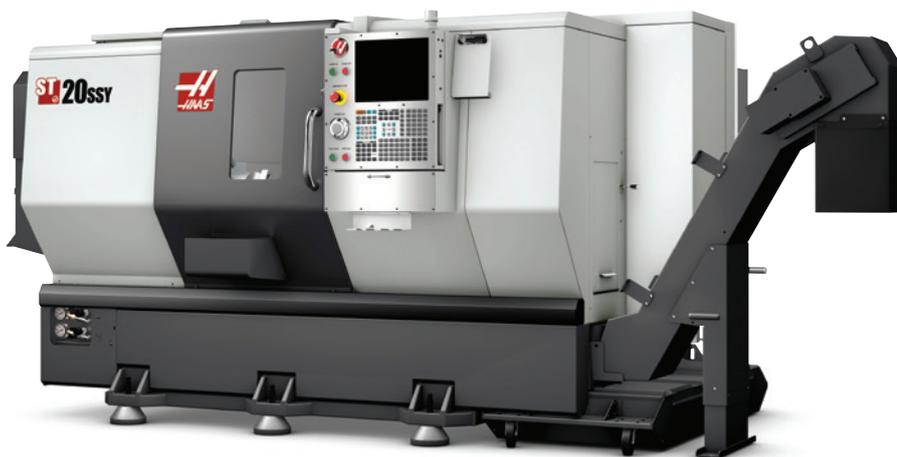
**Haas ST20SSY mit Servo Bar 300 (mit Stangenlader)**
