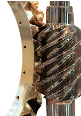
Schneckenwellen bis  $\varnothing$  200 mm. Maximales Modul 16. Eingängig und mehrgängig. Gefräst oder geschliffen. Ob als Standardteil oder nach Zeichnung. Einzel-, Serie- oder Musterfertigung.
