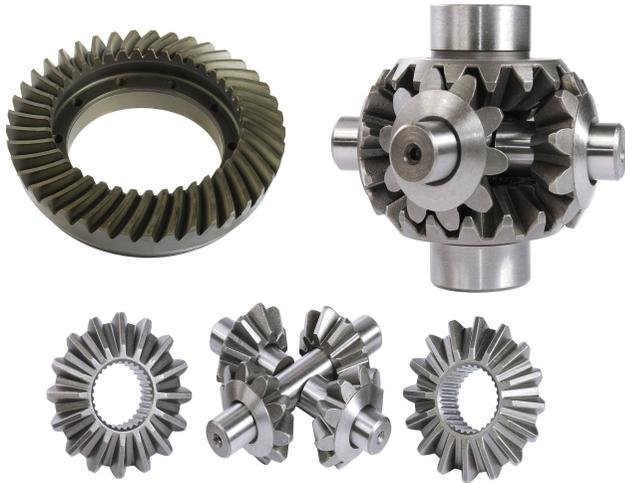
Gerade oder schräg verzahnte Kegelräder bis zu  $\varnothing$  750 mm. Maximales Modul ist 16. Spiralverzahnung palloid gefräst bis Modul 7 oder zykl-palloid geläpft als HPG-Verzahnung bis Modul 13.
