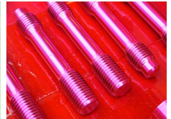
PT-Prüfung / Farbeindringverfahren
