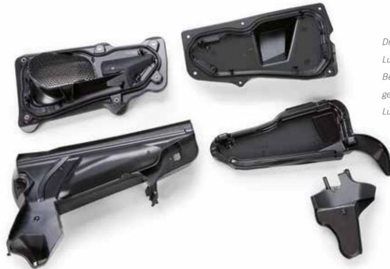
Die Kunststoffkomponenten für die Luft-Wasser-Trennung werden im Bereich Frontscheibe/Motorraum eingebaut und trennen die anströmende Luft vom Regenwasser.
