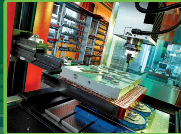
Unsere Senkerodiermaschinen sind vollständig automatisiert und in eine verkettete Anlage eingebunden. Das macht sie vielseitig nutzbar und hält die Durchlaufzeiten der Werkstücke sehr kurz.
