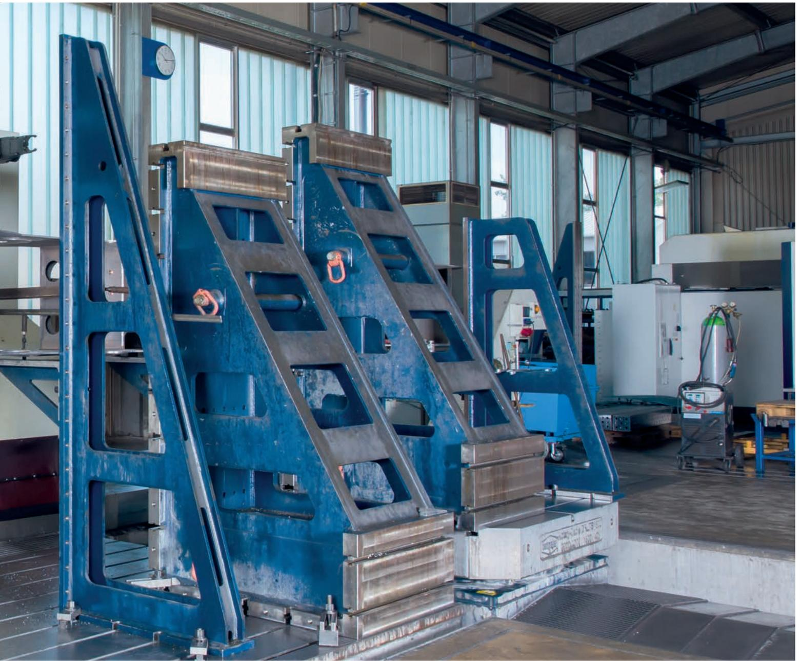
Mittelgroße Bauteile werden auf unserem Bearbeitungszentrum Bimatec Soraluca TA 35 mit einem Verfahrweg in X mit 3500, Y 1200 und Z 1200 mm bearbeitet.
