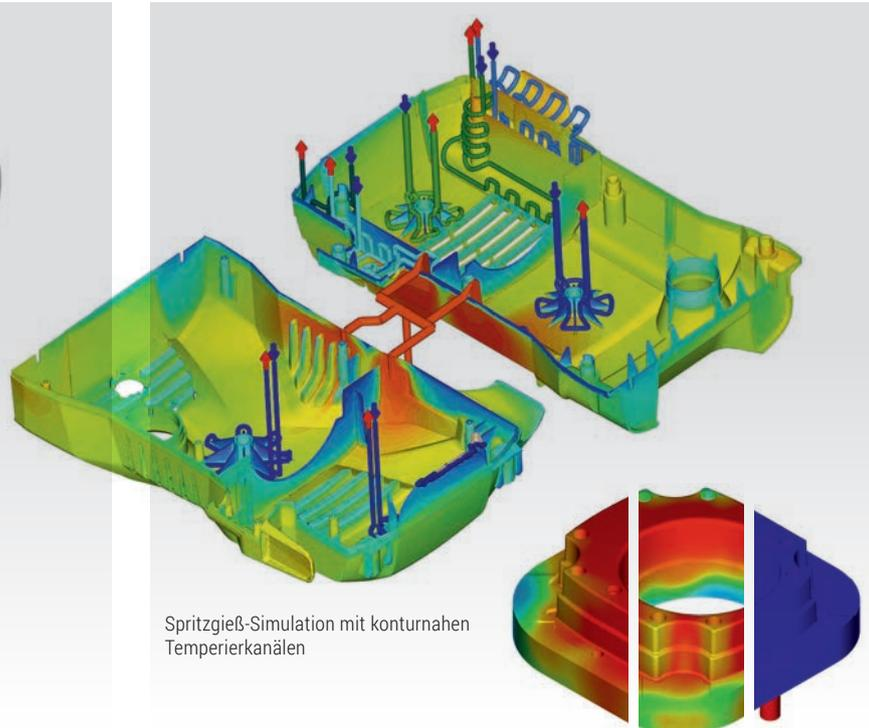
Spritzgieß-Simulation mit konturnahen Temperierkanälen
