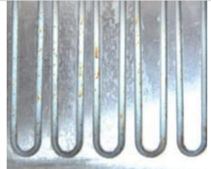
beschichtete Kanäle nach 230 Stunden Salzsprühnebeltest mit minimaler Korrosion
