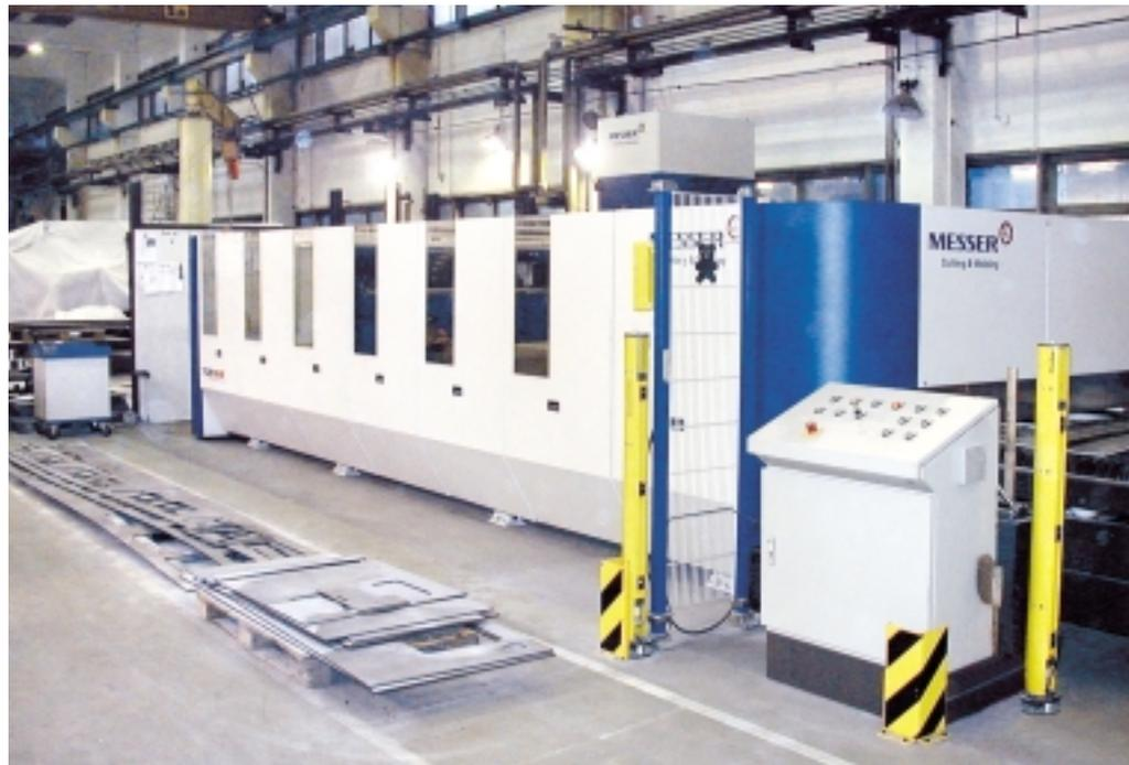
*Laserschneidmaschine Messer-Cutting & Welding Multilas 6020*
