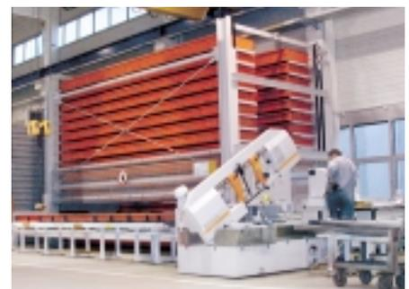
*Langgutkassettenlager mit Säge*
